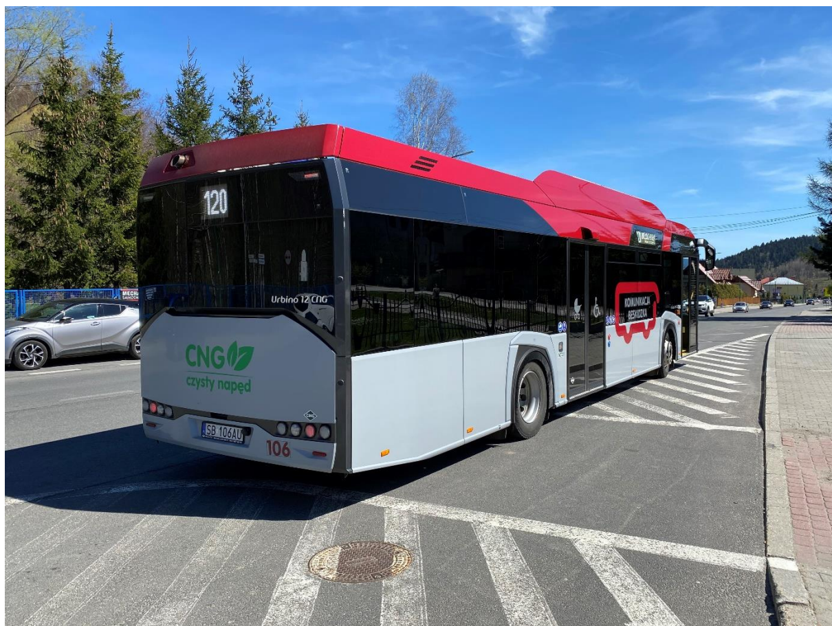
Rys. 8.3 Oznakowanie niskoemisyjnego autobusu Komunikacji Beskidzkiej, napędzanego CNG. Źródło: Materiały własne
